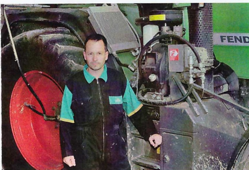
Adrian Arni hat den Zusatzkompressor rechts von der Kabine montiert.
