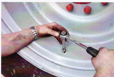
Bei der Montage wird ein Loch in die Felge gebohrt und anschliessend ein Kugelhahn montiert. (Fotos: Strotmann)
