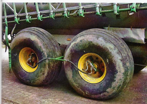
Am Anhänger genügt für beide Achsen eine Leitung.
