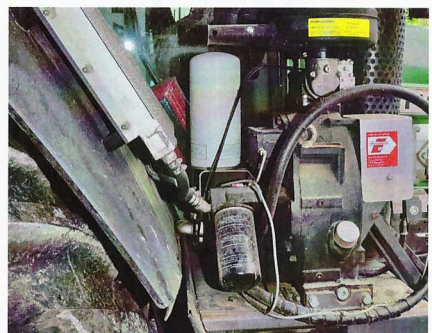
Ein Abscheider sorgt dafür, dass kein Öl in die Leitungen gelangt.
