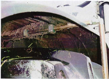
Die Rohrleitungen werden durch den Kotflügel geführt.
