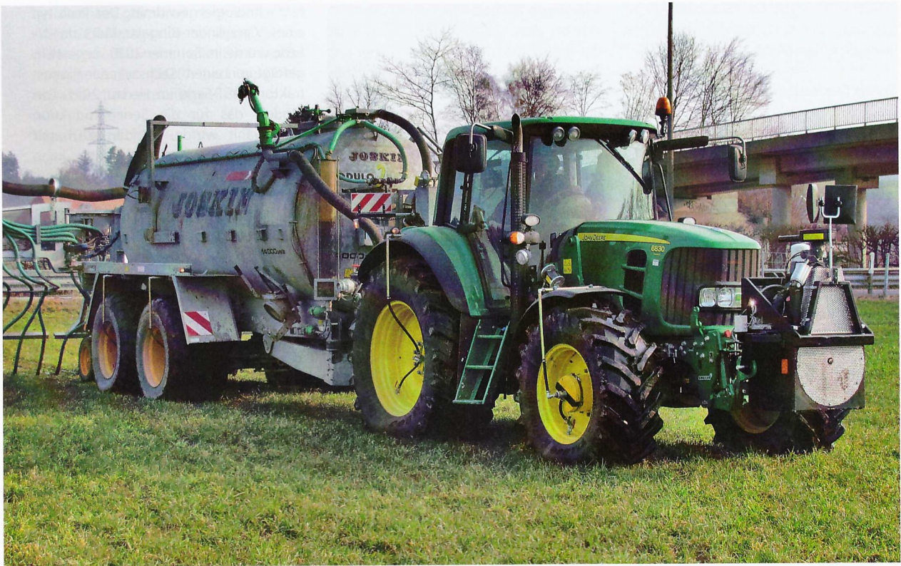
Mit reduziertem Luftdruck wird das Fahrzeuggewicht auf einer grösseren Fläche abgestützt. Der Zusatzkompressor ist an der Fronthydraulik montiert. (Bilder: Ruedi Burkhalter)
