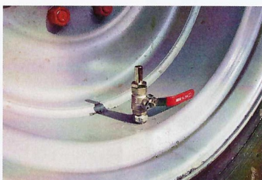
Bei der Montage wird ein Loch in die Felge gebohrt und anschliessend ein Kugelhahn montiert. (Fotos: Strotmann)
