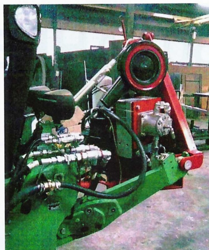
Hier wurde der Kompressor in das Akkorddreieck integriert.
