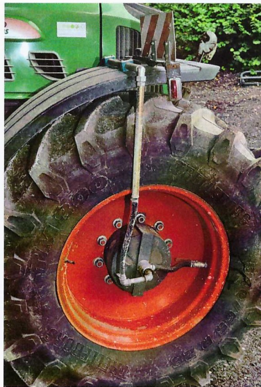
Die Halterungen der Drehübertrager werden aus Flacheisen gefertigt.
